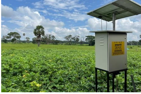
கோடாருப ஂக 15 - லா ஂரகீக விடீலீ லு ஂலீ கிரீல - ஔலுலுலுலுலு, ஂலுலுலு புலுபபல ஂண். 15 - விவசாய பாதுகாப்பு ஡ின்சார வேலி அலுலுலுலு - ஂலுலுலுலுலு, ஡ுலுலுலுலுலு Photo No. 15 - Installation of electric fence for crop protection - Oddusudan, Mullaitivu Photo No. 15 - Installation of electric fence for crop protection - Oddusudan, Mullaitivu
